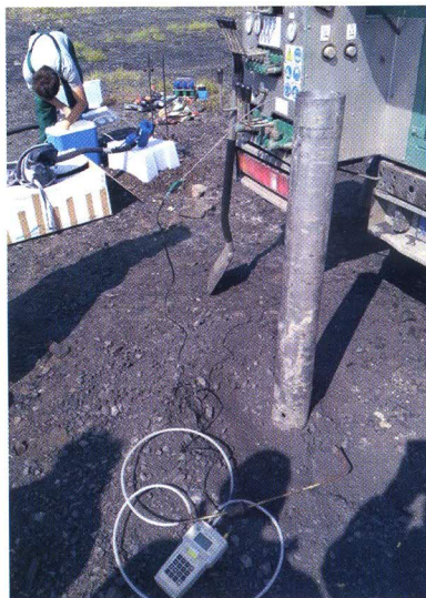
W ramach badań specjaliści z Głównego Instytutu Górnictwa wykonywali otwory obserwacyjne o głębokości 10 metrów.
